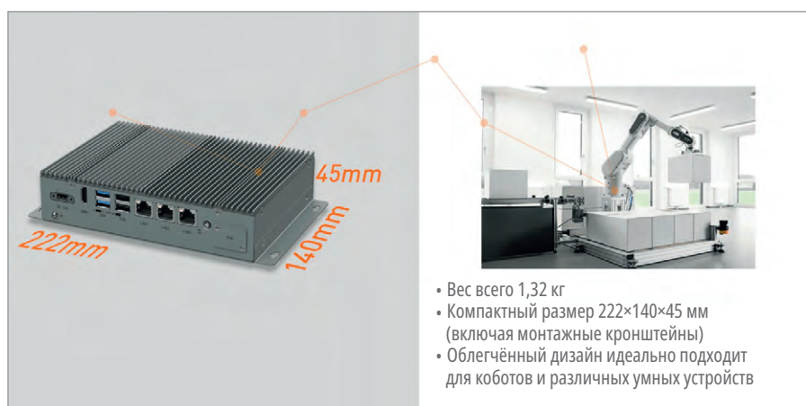
Рис. 3. Преимущества компактного дизайна KMDA-2631
