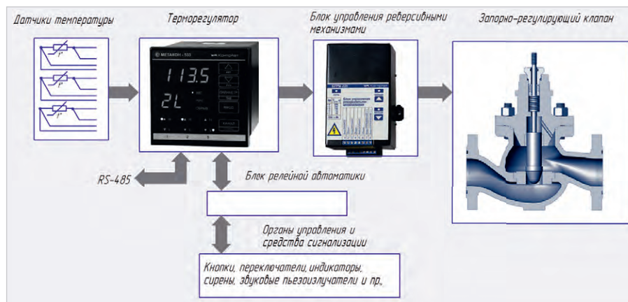
Рис. 3. Структурная схема локальной АСУ ТП с реализацией ПИД-регулирования для электроприводной арматуры
