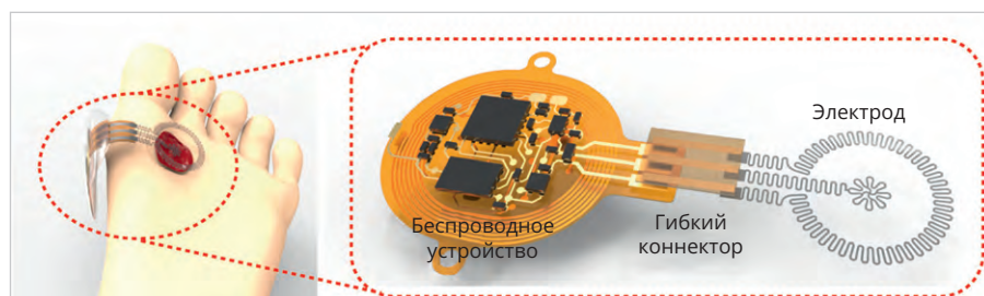
Рис. 1. Материалы и конструкции биорезорбируемой, беспроводной и безбатарейной системы электротерапии
