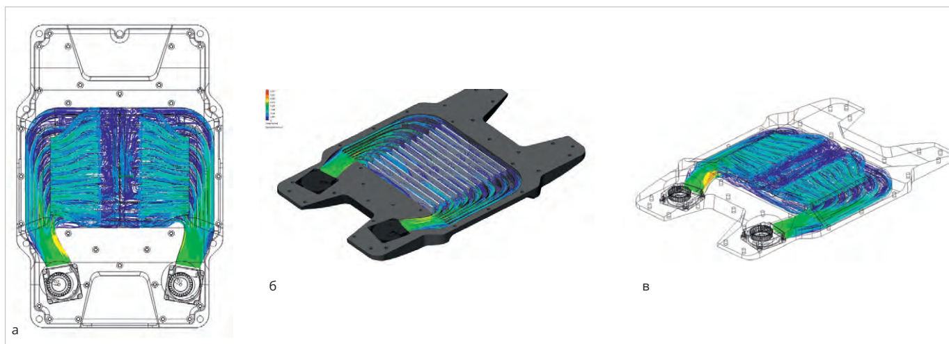
Рис. 3. Тепловой расчёт модели георадара
