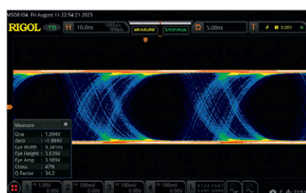
Рис. 13. Срыв формирования тактового сигнала при построении ГД при чрезмерно малом коэффициенте демпфирования и слишком широкой полосе пропускания фильтра ФАПЧ
