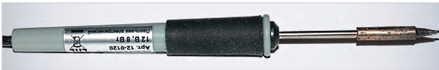
Рис. 38. Мини-паяльник 12 В, 8 Вт
