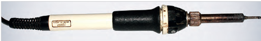
Рис. 40. Паяльник 220 В, 20 Вт
