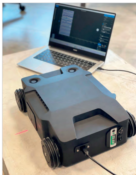
Рис. 1. Тестовый стенд, состоящий из георадара (прототип), подключённого ноутбука с предустановленным ПО и экспериментального бетонного блока
