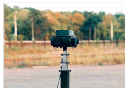
Рис. 13. Внешний вид «Сerp-BC» – системы подавления радиочастот управления БПЛА
