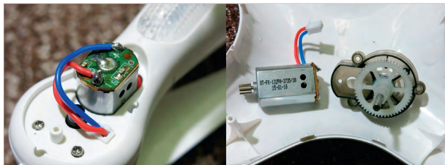
Рис. 8. Вид на электродвигатель и элементы привода мультикоптера
