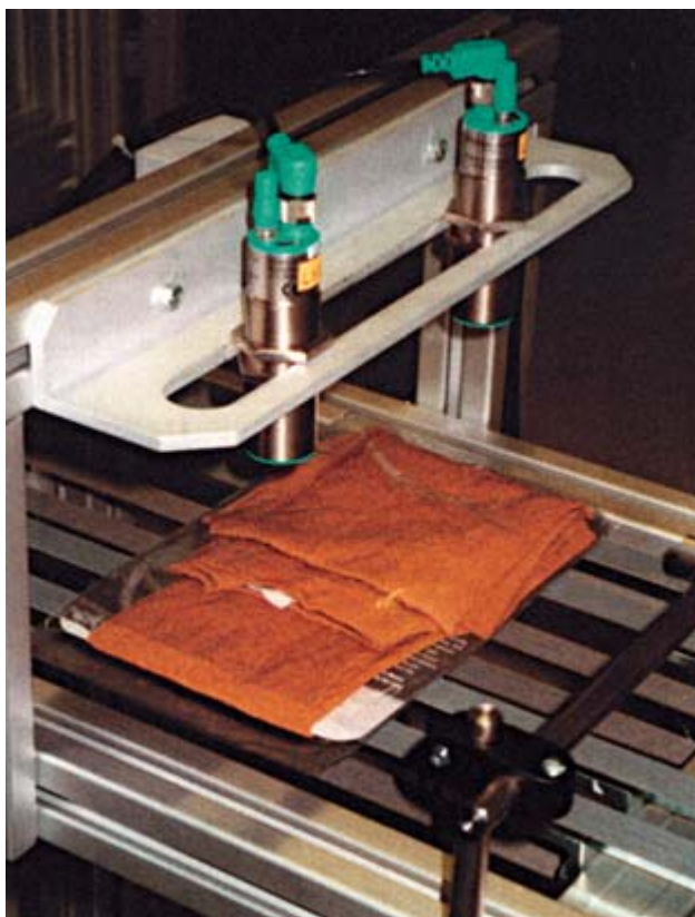
Рис. 18. Определение ориентации пакетов на упаковочной линии
