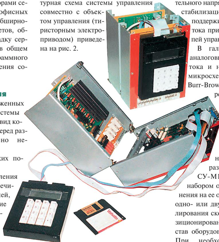
Рис. 1. Внешний вид и внутренняя компоновка СУ-М1
