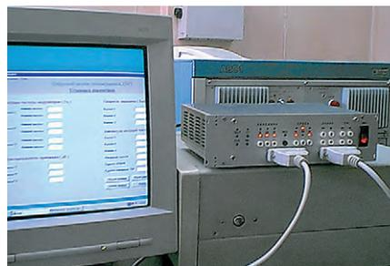
**Рис. 3. Подключение модема ЦМТ-3 к компьютеру**
