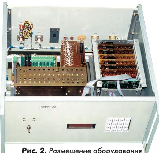
Рис. 2. Размещение оборудования ПУРИ в металлическом каркасе
