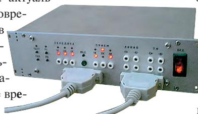
Рис. 1. Многофункциональный модем ЦМТ-3
