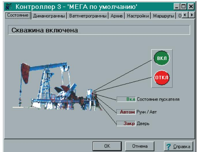
Рис. 11. Управление работой скважины из диспетчерского пункта
