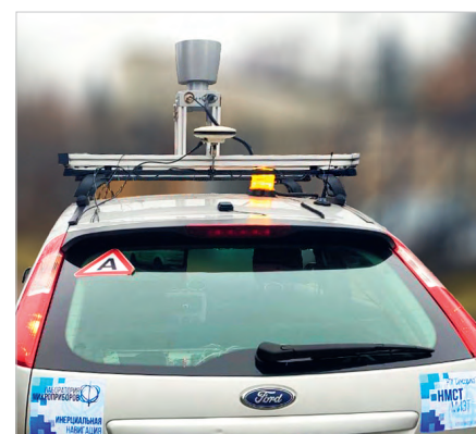
Рис. 3. Беспилотная система, созданная кафедрой «Организация и безопасность движения» МАДИ, с инерциальной навигационной системой ООО «ЛМП»
