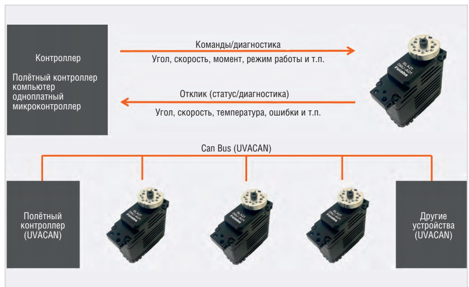
Рис. 4. Пример соединения и обмена данными по CAN-шине
