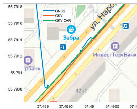
Рис. 8. Сравнение траекторий автомобиля при проезде под мостом:
