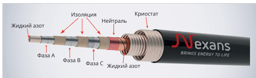
Рис. 6. Конструкция высокотемпературного сверхпроводящего кабеля фирмы Nexans
