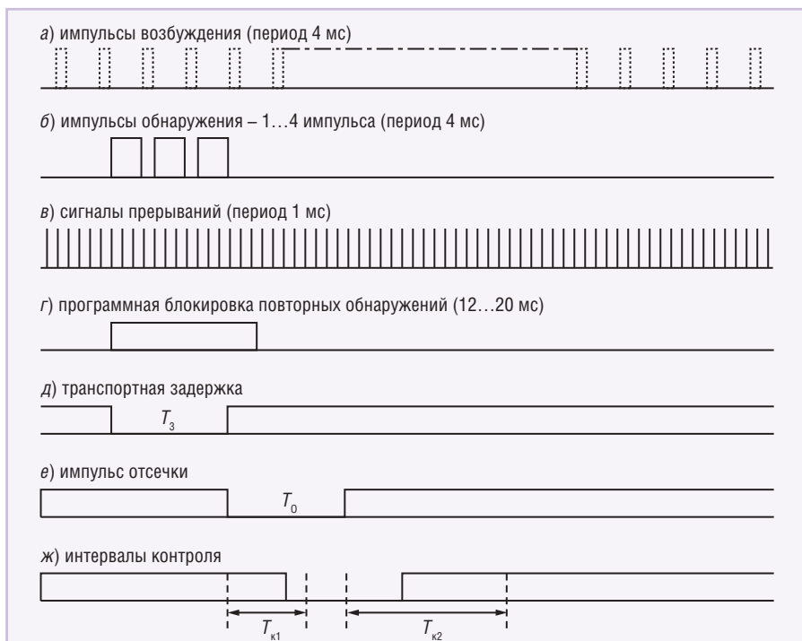
Рис. 1. Диаграмма, поясняющая временные соотношения в функционировании подсистем сепаратора
