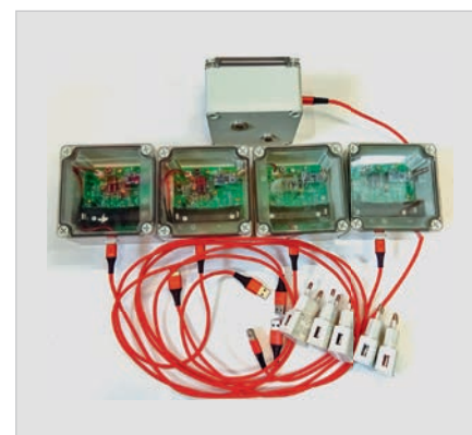
Рис. 11. РПТ в монтажных коробках
