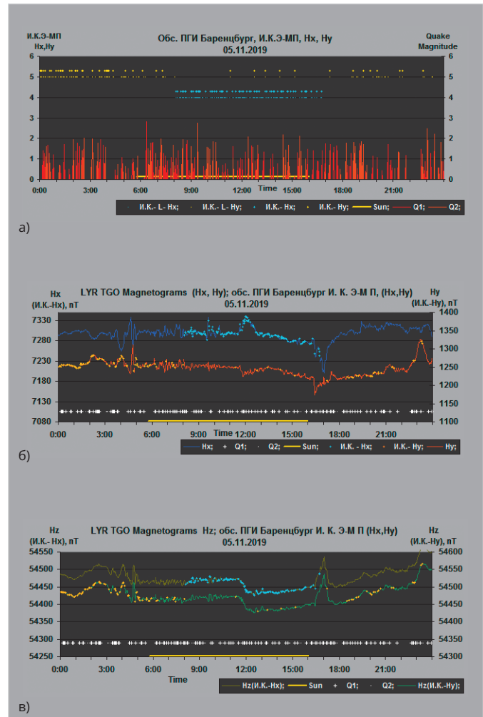
Рис. 4. Синхронная запись АВХ импульсной составляющей ОНЧ-сигнала при двухуровневом алгоритме распознавания (И.К. – Нх, Ну и И.К. – L – Нх, Ну), сейсмической активности (Q1, Q2), компонент магнитного поля Земли (Нх, Ну, Нз) и периода времени освещённости нижней ионосферы (sun) [обс. ПГИ Баренцбург]:
