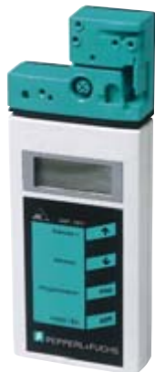
Рис. 15. Устройство адресации и диагностики slave-устройств AS-интерфейса
