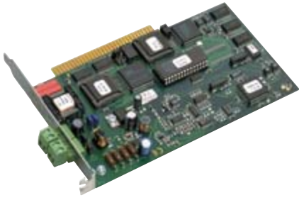
Рис. 13. Master-устройство AS-интерфейса для установки в ISA-слот IBM PC совместимого компьютера
