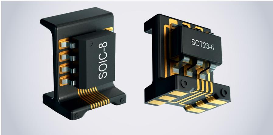
Рис. 1. Монтажное основание с установленным на нём компонентом
