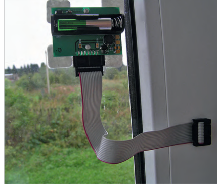
Рис. 9. Способ установки датчика сбора информации на окне
