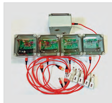
Рис. 11. РПТ в монтажных коробках
