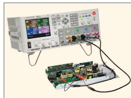
**Рис. 13. Анализатор источников электропитания фирмы Agilent**
