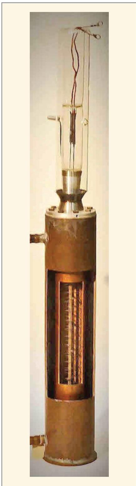
**Рис. 3. Мощная радиолампа (25 кВт) с охлаждением проточной водой в разрезе. Музей НРЛ**
