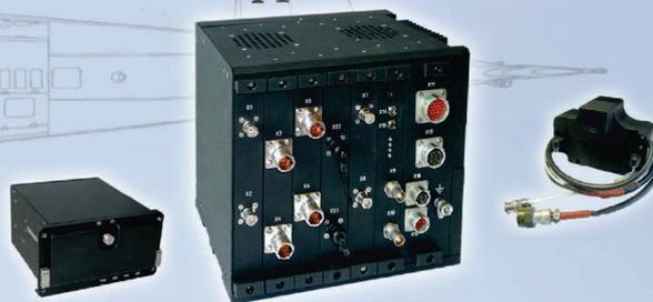
СВР-Ц предназначена для многоканальной регистрации видеоинформации от многофункциональных индикаторов и телевизионной камеры, установленной на объектах типа Ка-52.
