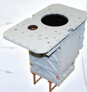
АВУ входит в состав межвидовой астроинерциальной навигационной системы (АИНС), предназначенной для использования на самолете. Функцией АВУ является обеспечение астрокоррекции БИНС, с которой АВУ связано конструктивно, электрически и информационно.
