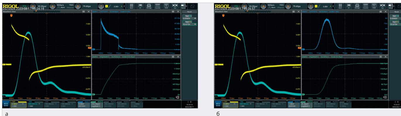
Рис. 17. Результаты измерений, полученные для импульсов длительностью 40 мкс интегрированием квадрата: а) выходного напряжения СФ; б) выходного напряжения СФ
