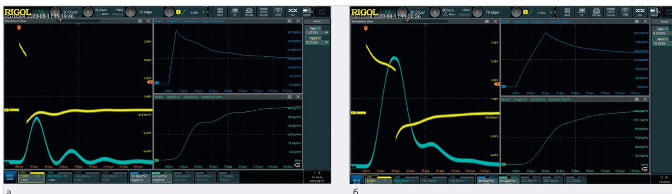
Рис. 15. Результаты измерений электрической площади сигнала на входе и выходе СФ для импульсов длительностью: а) 10 мкс; б) 40 мкс
