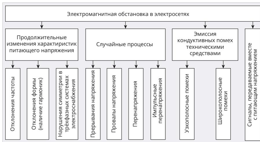
Рис. 1. Составляющие электромагнитной обстановки в сетях электропитания
