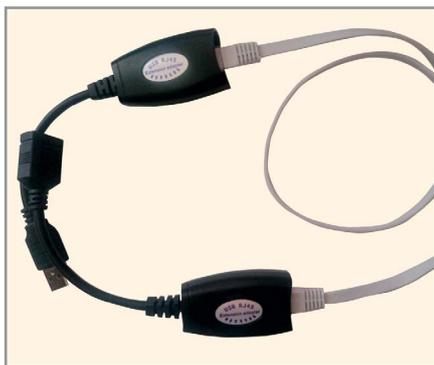
Рис. 8. Преобразователи USB-8P8C для реализации цифрового тракта
