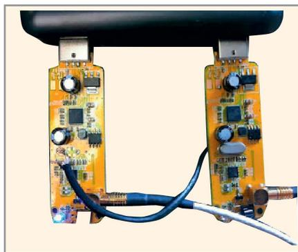
Рис. 9. Когерентный двухканальный приёмник на основе двух SDR-приёмников
