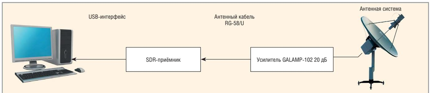
Рис. 7. Приёмный тракт с использованием программно-определяемого радио
