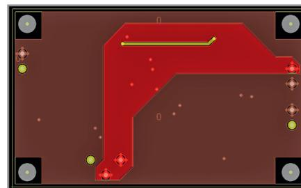
Рис. 33. Вид слоя Bottom после создания полигонов
