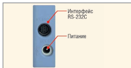
Рис. 3. Интерфейс RS-232C и гнездо питания
