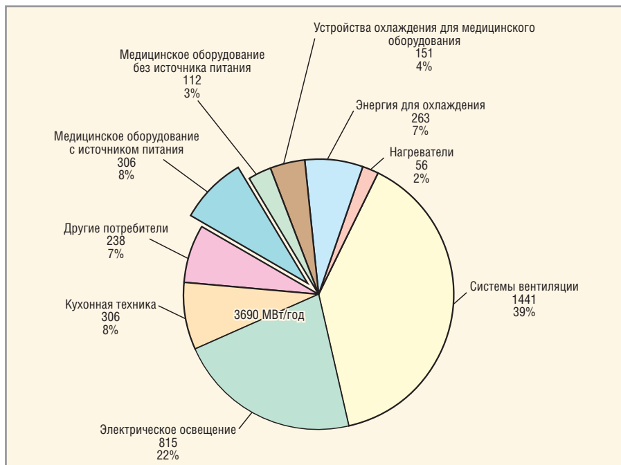
Рис. 1. Потребляемая мощность (МВт/год) по категориям, количеству установленного оборудования и в процентах
