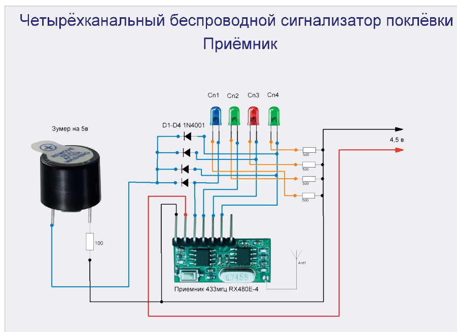
Рис. 10. Приёмник на модуле RX480E-4
