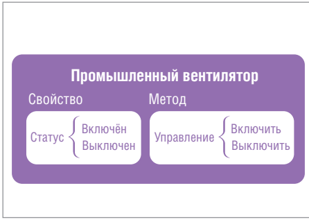
Рис. 2. Структурная схема класса, описывающего промышленные вентиляторы
