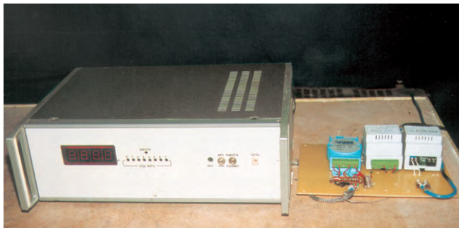
Рис. 2. Измерительный блок ДВО-2, модуль ADAM-4012 и радиомодем
