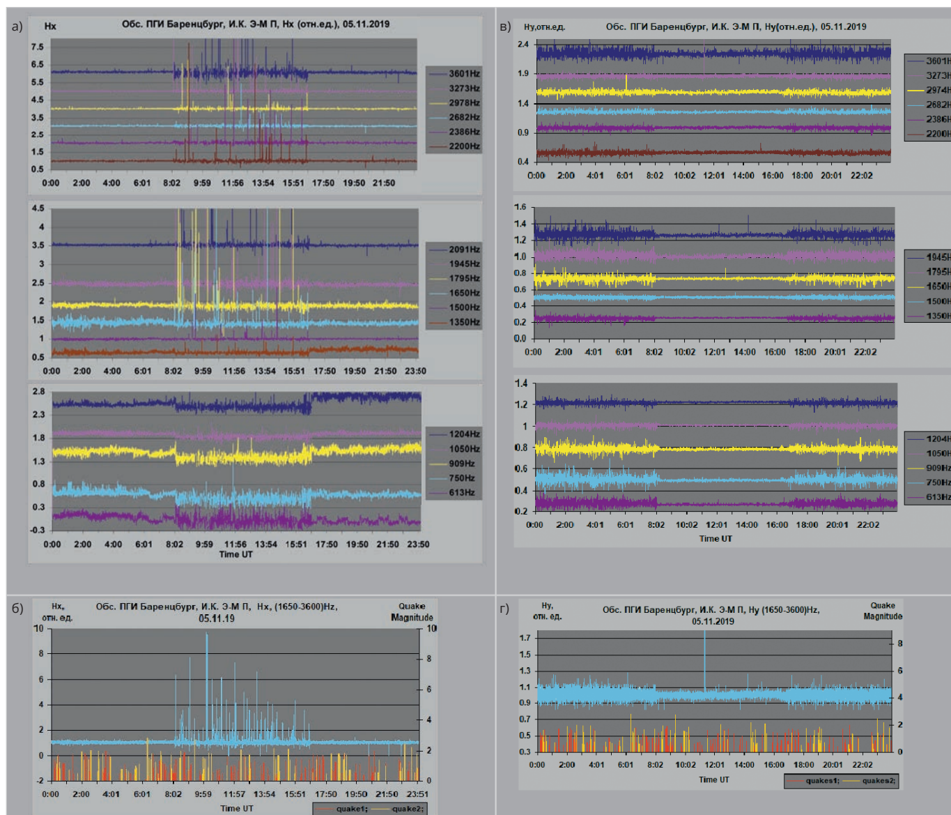
Рис. 4. Синхронная запись АЧХ И.К. Э-М. П. и сейсмической активности, период записи 05.11.2019: а) АЧХ И.К. Э-М. П. [Hx]; б) синхронная запись АВХ И.К. Э-М. П. [Hx] и сейсмической активности (quakes 1, 2); в) синхронная запись АВХ И.К. Э-М. П. [Hy] и сейсмической активности (quakes 1, 2)
