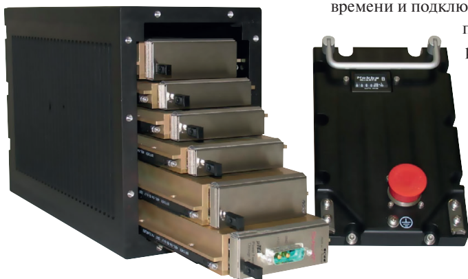
Рис. 1. Пример вычислительной системы с кондуктивным охлаждением по спецификации MicroTCA.3
