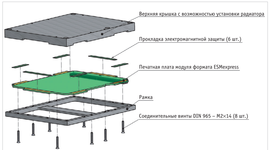
Рис. 1. Схема конструкции КМ ESMexpress согласно стандарту ANSI/VITA 59
