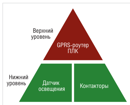
Рис. 1. Структура аппаратуры шкафа управления
