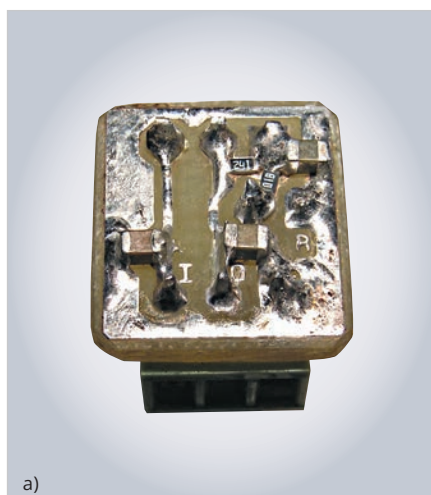
Рис. 10. Внешний вид платы регулируемого стабилизатора: а – вид со стороны разводки, б – вид с обратной стороны
