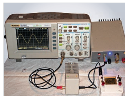
Рис. 17. Подключение усилителя к генератору, ИП и осциллографу
