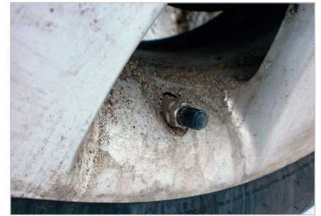
Рис. 3. Смонтированный на диске колеса электронный датчик с модулем беспроводной связи и «безбатарейным» источником питания
