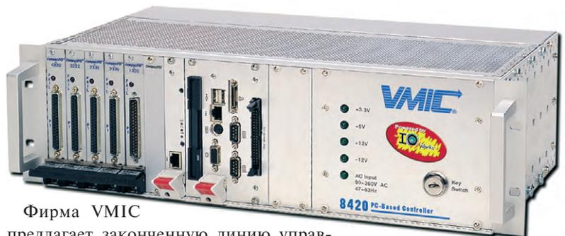
Фирма VMIC предлагает законченную линию управляющих систем на базе PC-контроллеров. Используя стандартные персональные компьютеры на базе шин PCI, CompactPCI и VME под управлением IOWorks, заказчик получает гораздо более
