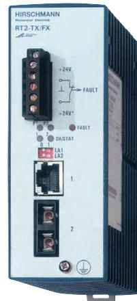
Рис. 2. Внешний вид повторителя RT2
