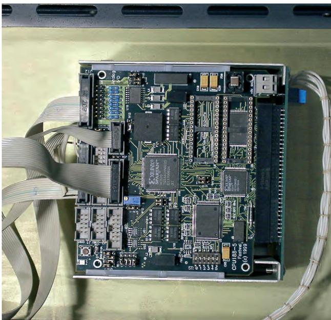
Рис. 5. Каркас 5253 с модулями CPU188-5MX и АО16-V8
