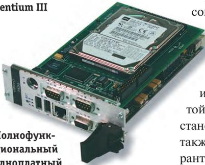
Полнофункциональный одноплатный компьютер 3U CompactPCI
