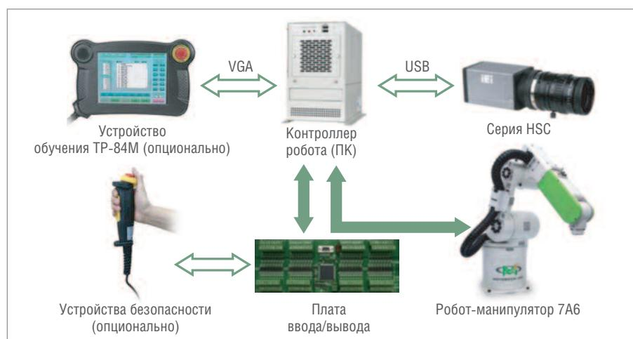
Рис. 2. Архитектура системы позиционирования
