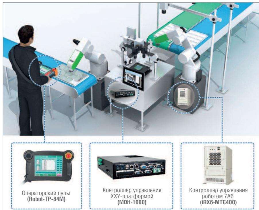
Рис. 1. Машиное зрение на автоматизированном конвейере
