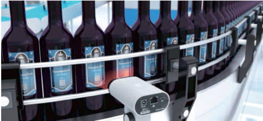
Рис. 5. Промышленная система машинного зрения на конвейере
