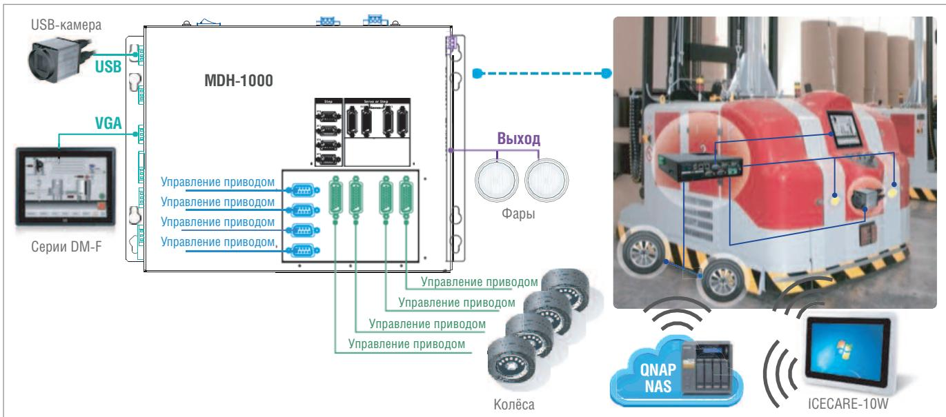
Рис. 4. Управление автономным транспортом при помощи MDH-1000
