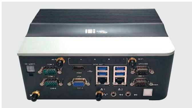
Рис. 14. Автомобильная встраиваемая система IVS-100-BT
