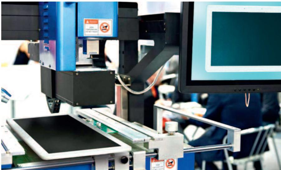
Рис. 6. Проверка качества ЖК-videопанелей на конвейере
