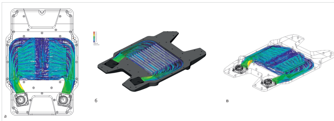
Рис. 3. Тепловой расчёт модели георадара
