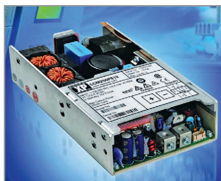
Рис. 6. Источник питания CCM250 (XP Power) использует оптимизированную механическую конструкцию 250-Вт (пиковая мощность 300 Вт) источник питания с конвекционным охлаждением помещён в корпус с размерами 152,4 × 101,6 × 38,1 мм
