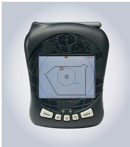
Рис. 15. Трекер с обратной связью и дисплеем
