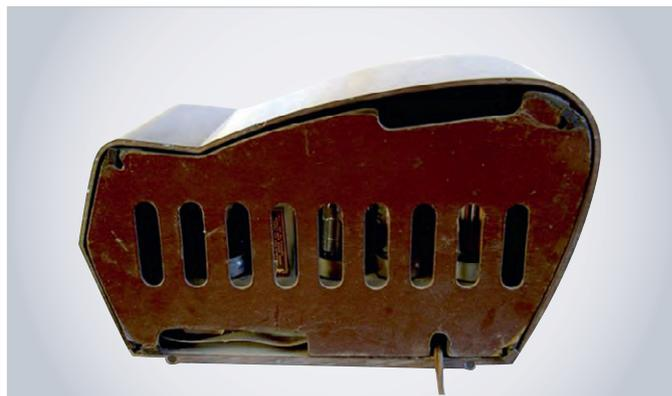
Рис. 14. Простой приёмник германского производства для УКВ-диапазона. Вид со стороны задней стенки
