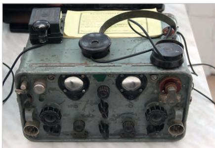
Рис. 12. КВ-радиостанция «РАФ-КВ-3»
