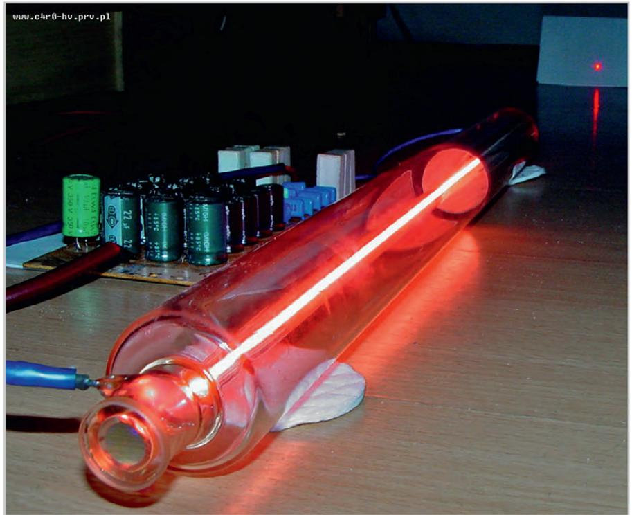
Рис. 6. Лабораторный гелий-неоновый газовый лазер [33]
