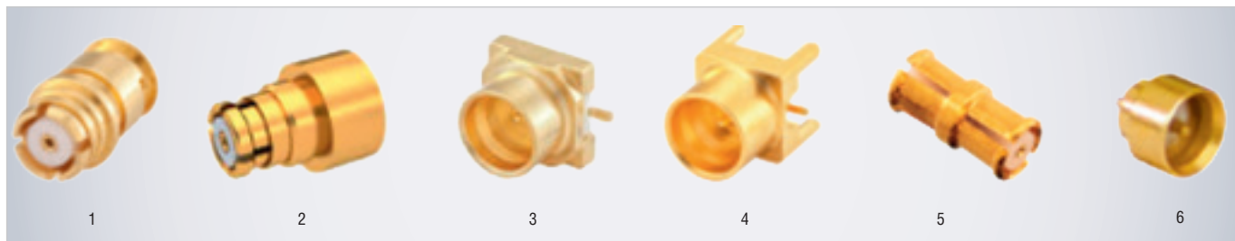
Рис. 7. Соединители 2,92 мм: 1 – розетка кабельная под полужёсткий кабель, 2 – вилка кабельная под полужёсткий кабель, 3 – вилка кабельная угловая под полужёсткий кабель, 4 – КМПП розетка, 5 – фланцевый вывод энергии розетка, 6 – концевая розетка для установки на печатную плату
