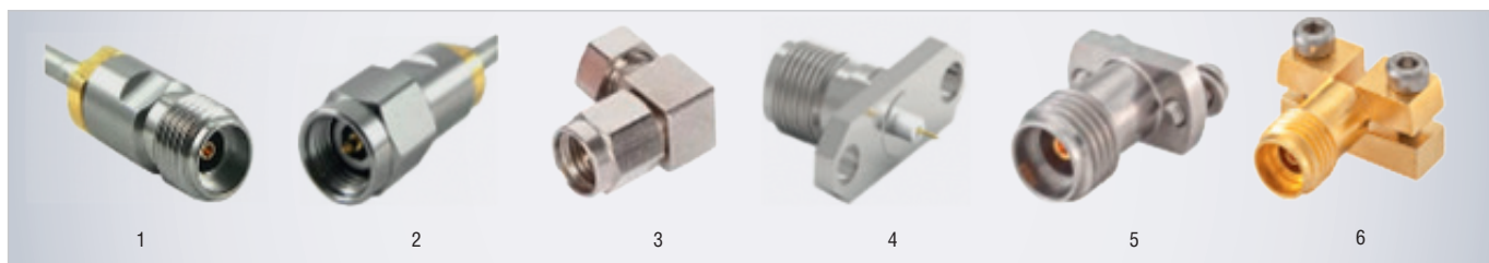
Рис. 7. Соединители 2,92 мм: 1 – розетка кабельная под полужёсткий кабель, 2 – вилка кабельная под полужёсткий кабель, 3 – вилка кабельная угловая под полужёсткий кабель, 4 – КМПП розетка, 5 – фланцевый вывод энергии розетка, 6 – концевая розетка для установки на печатную плату
