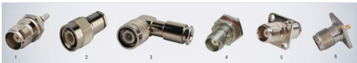
Рис. 5. Соединители TNC: 1 – прямая кабельная розетка, 2 – прямая кабельная вилка, 3 – угловая кабельная вилка, 4 – проходная панельная розетка, 5 – фланцевая панельная кабельная розетка, 6 – КМПП
