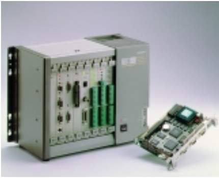
Рис. 14. Модульный промышленный компьютер MIC-2000
