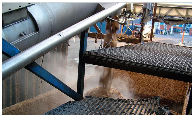
Рис. 4. Вид резервуара для сброса отработанного сырья пивоваренного производства – дробины. Завод ОАО «Пивоваренная компания «Балтика», 2020 г.
