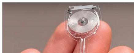
Рис. 1. Внешний вид гибкого растворяемого имплантата с электронными элементами
