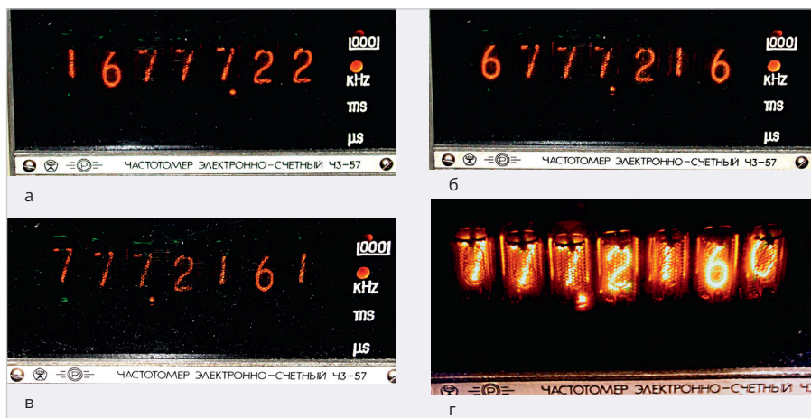
Рис. 8. Настройка кварцевого резонатора на частоту 16 777 216 Гц, а – T = 0,1 с; б – T = 1 с; в, г – T = 10 с
