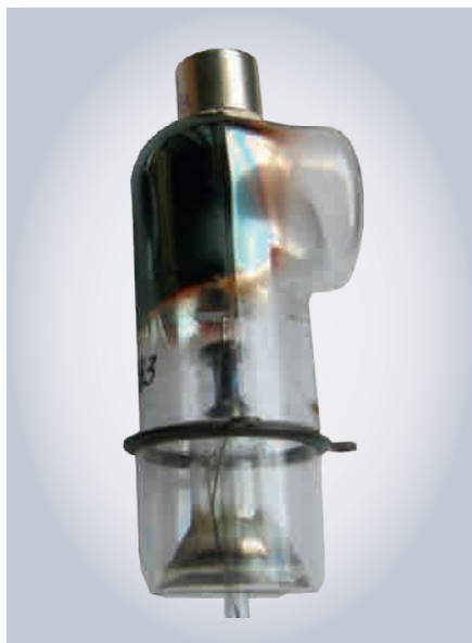
Внешний вид фотоэлемента Ф-4 (из коллекции автора)
