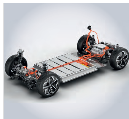
Рис. 9. Система на шасси электромобиля для локализации возгораний АКБ
