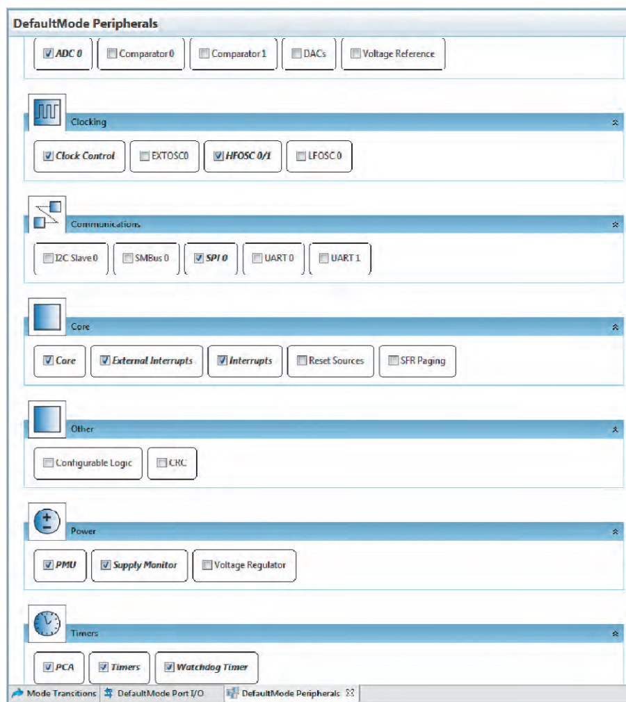
Рис. 8. Общее меню настроек периферийных устройств МК
