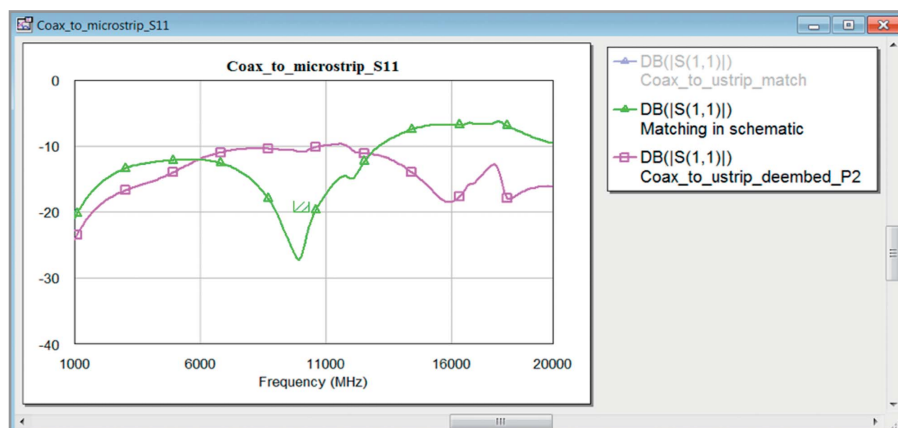
Рис. 5. График частотной зависимости модуля коэффициента отражения перехода с учётом согласующей цепи, элементы которой представлены аналитическими моделями (зелёная линия)
