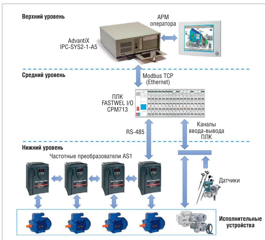
Рис. 1. Структурная схема АСУ ТП многотопливного котла
