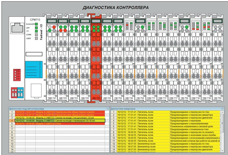
Рис. 7. Окно диагностики контроллера и приводов
