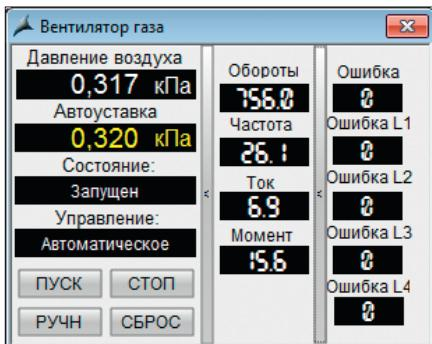
Рис. 8. Окно управления и диагностики привода
