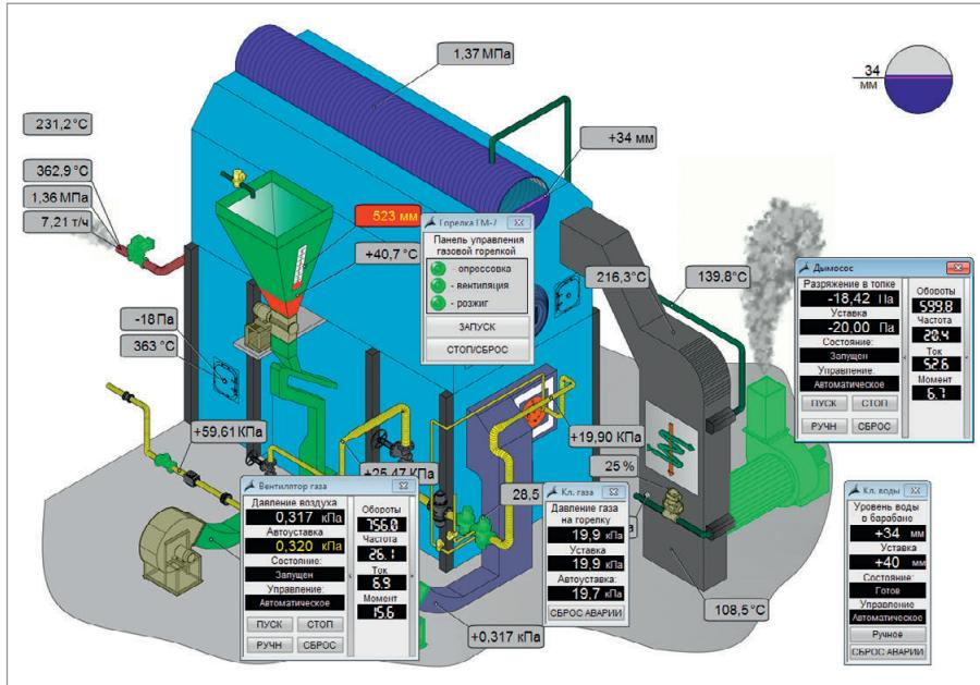
Рис. 4. Мнемосхема многотопливного котла Е-16-21-350 ГМДВ
