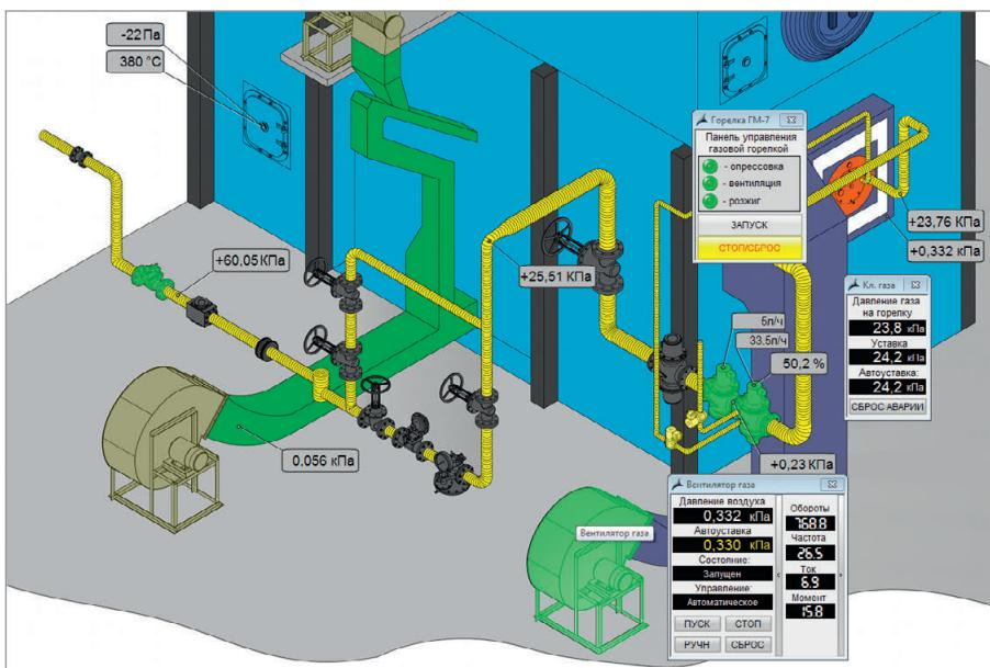
Рис. 5. Крупный план газовой части мнемосхемы многотопливного котла Е-16-21-350 ГМДВ
