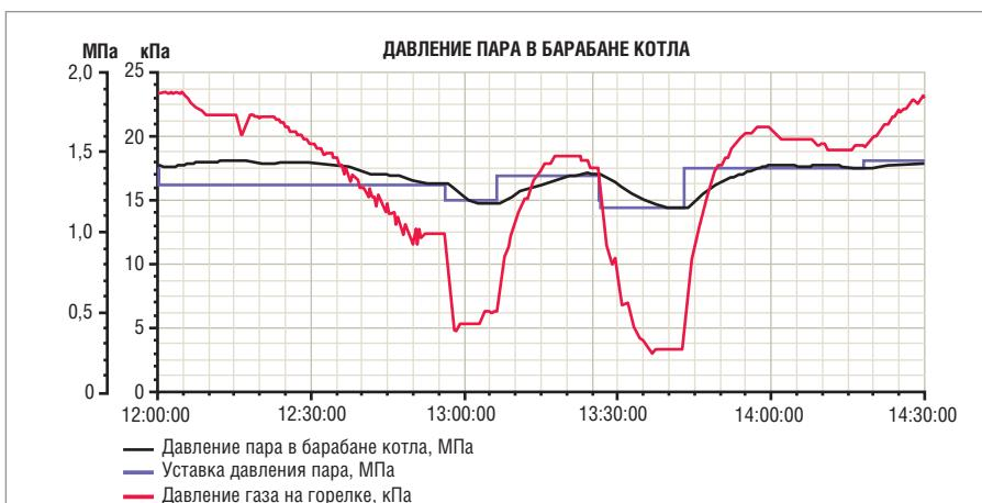
Рис. 9. Зависимость давления пара в барабане от давления газа на горелке
