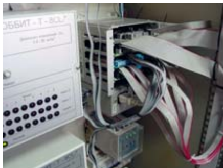
Рис. 5. Монтажный каркас 5205-RMH Octagon Systems в собранном виде
