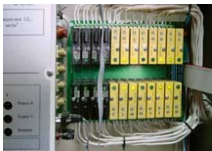
Рис. 6. Модули УСО фирмы Grayhill серии G5 на платах МРВ-24 Octagon Systems
