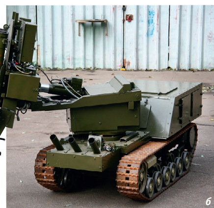
Рис. 1. Мобильный робототехнический комплекс МРК-47БТ военного назначения в положении плеча и платформы для стрельбы по воздушным целям (а) и по целям на дне оврага (б)
