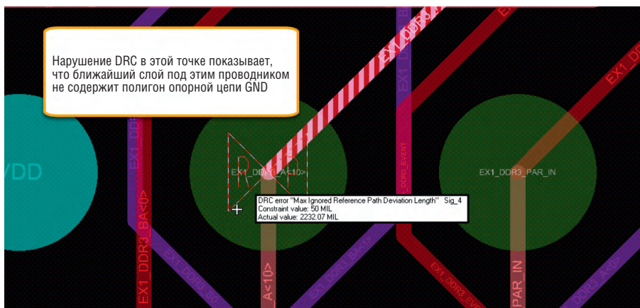
Рис. 11. Пример индикации ошибки Return Path на печатной плате
