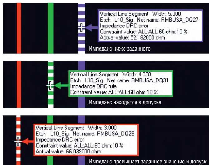
Рис. 8. Просмотр импеданса проводников с помощью индикатора выполнения DRC-правила по импедансу
