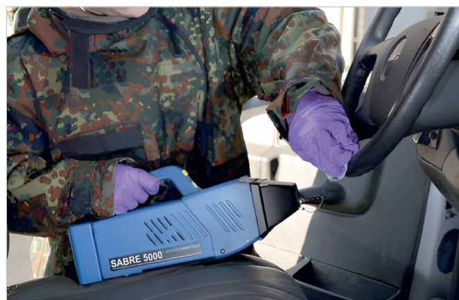
Рис. 24. Пример контроля «закрытых мест»
