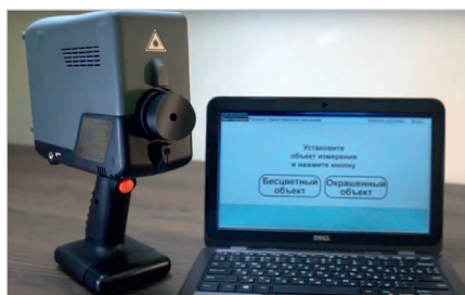
Рис. 12. Устройство контроля в формате спектрометр плюс ноутбук с ПО
