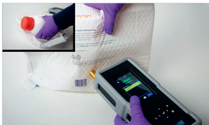
Рис. 23. Пример контроля почтовой корреспонденции с помощью TacticID-GP Plus
