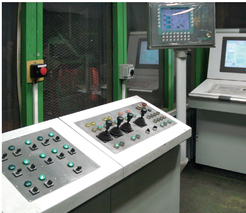
Рис. 2. Пульт управления в диспетчерском пункте (на заднем плане видны панели оператора, относящиеся к устройствам человеко-машинного интерфейса верхнего уровня системы управления)
