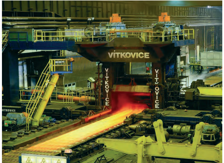
Рис. 1. Сердце прокатного стана — 3,5-метровый пресс для проката листов толщиной от 5 до 70 мм и шириной до 3,3 м
