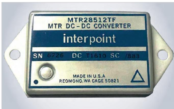
Рис. 1. Контрафактный гибридно-плёночный модуль
