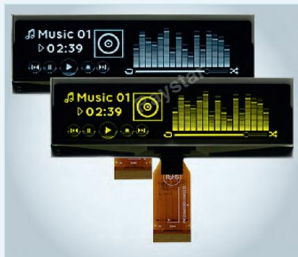
Доступны модели с цветами свечения экрана: жёлтый и белый. Дисплейный модуль способен работать в диапазоне температур от  $-40$  до  $+80^{\circ}\text{C}$ , диапазон температур хранения от  $-40$  до  $+85^{\circ}\text{C}$ .
