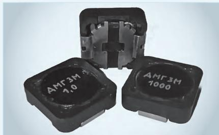
Дроссели предназначены для использования в DC-DC преобразователях и низкопрофильных вторичных источниках питания. Компактные размеры и маленькая масса в большей степени удовлетворяют требованиям для вторичных источников питания мобильных радиоэлектронных устройств:
