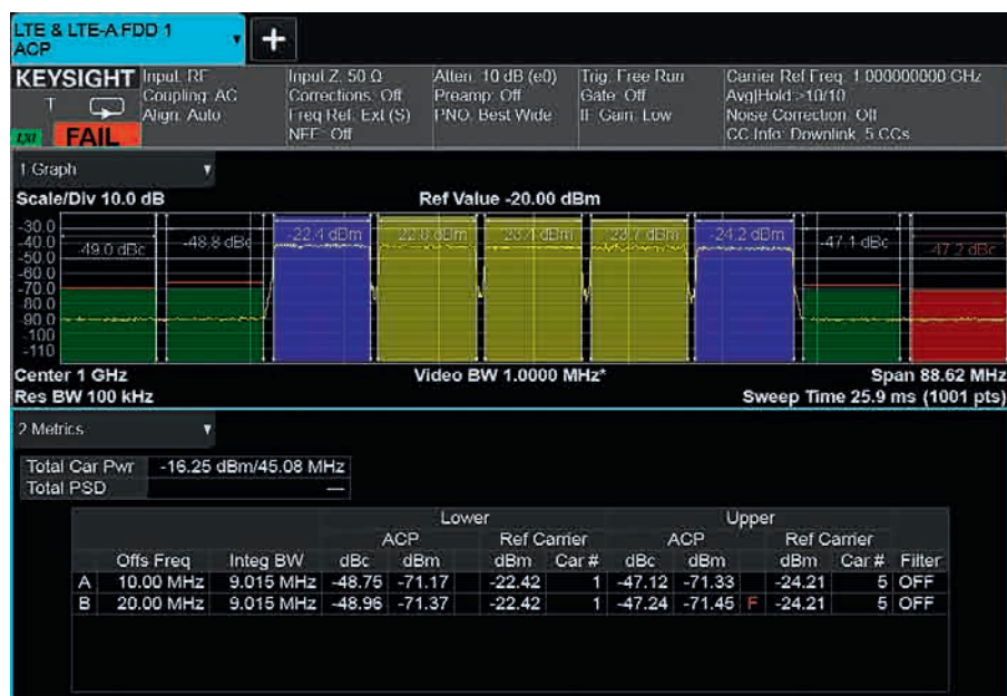
Рис. 2. Автоматизированное измерение коэффициента мощности в соседнем канале
