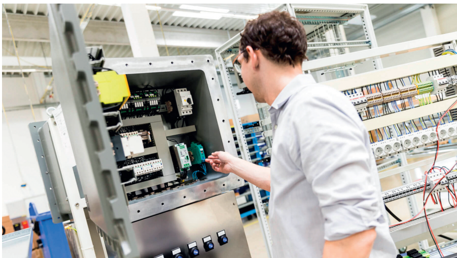
Рис. 13. Взрывозащищённый шкаф с элементами обеспечения безопасности
