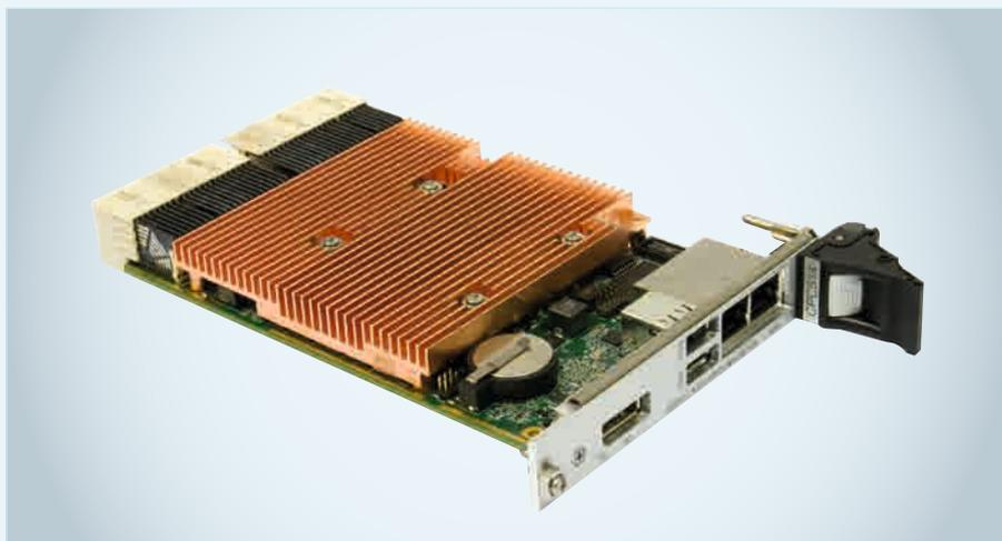
оснащён встроенными средствами аппаратного контроля и выпускается в двух вариантах исполнения: с принудительным охлаждением внешними вентиляторами или в «закрытом» конструктиве с встроенным кондуктивным охлаждением.
