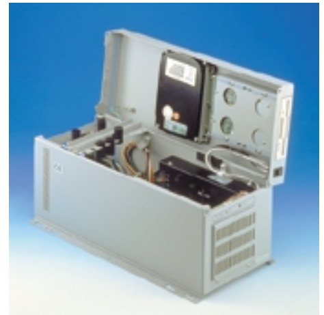
Рис. 7. Контроллер доступа на базе шасси IPC-6806 фирмы Advantech
